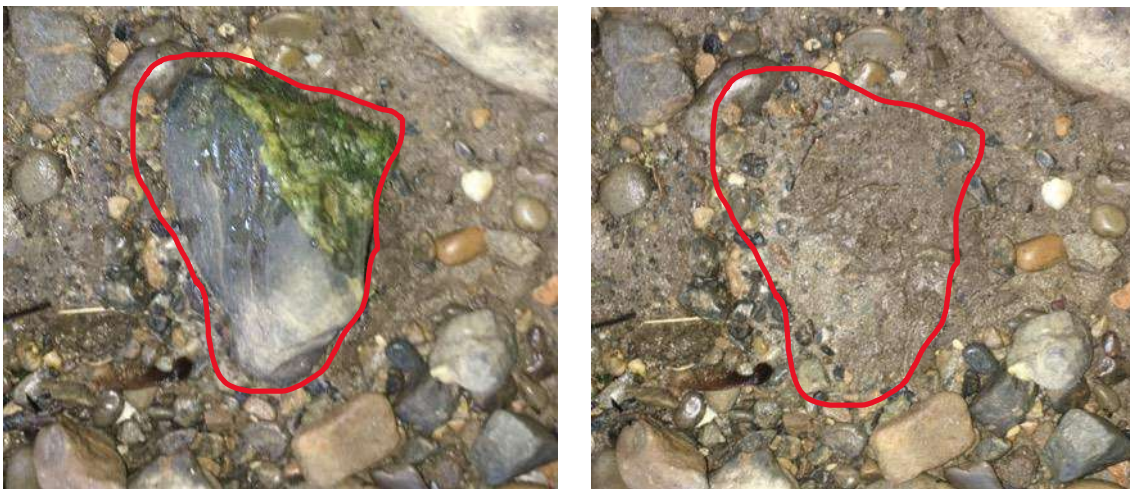
Abbildung 17: Entnahme der Deckschicht zur Beurteilung der Kolmation des Lattenbaches.
